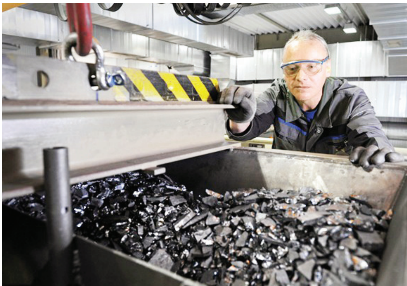
DAL RICICLO DI UN SINGOLO PANNELLO SI POSSONO OTTENERE 15 CHILOGRAMMI DI VETRO, TRE DI PLASTICA, DUE DI ALLUMINIO E UNO DI POLVERE DI SILICIO, OLTRE A POCO PIÙ DI UN ETTO DI RAME
