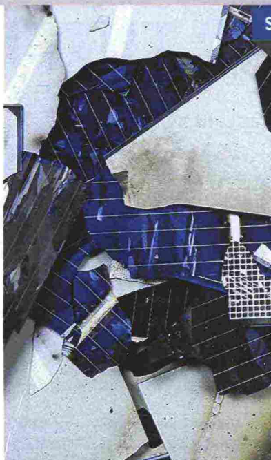
In alcune aziende (in foto: SolarWorld) i rifiuti di silicio provenienti dalla propria produzione vengono sottoposti a un processo di riciclaggio interno e depurati per il riutilizzo.
